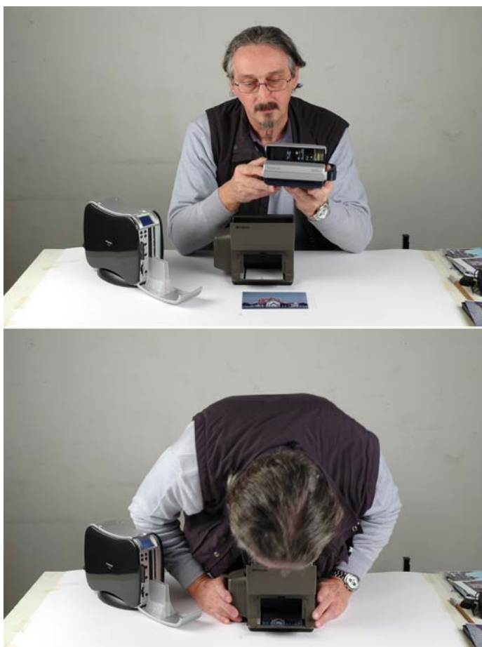
La Image 1200, viene innestata sul Close Up Stand, si controlla l'allineamento della stampa da riprodurre, si scatta.
